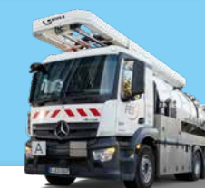
Saugwagen Spezialfahrzeug zur Tank- und Abscheiderentleerung und zum Transport von flüs- sigen gefährlichen Abfällen
