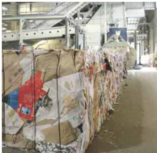
In der Altpapiersortieranlage wird gesammeltes Altpapier sortiert und zu Ballen gepresst.
