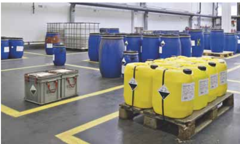
Im Schadstoffzwischenlager werden gesammelte Sonderabfälle kurzzeitig zwischengelagert.
